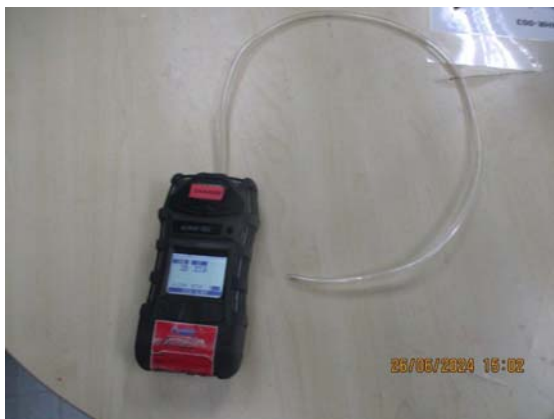
รูปที่ 52 Combustible Gas Detector
