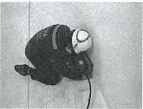
รูปที่ 37 ทำการตรวจสอบแนวซึมที่พื้นถัง ด้วยกล่องสุญญากาศ (Vacuum Box Test)
