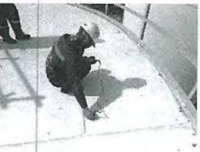
รูปที่ 39 ทำการวัดความหนาที่ถังข้างด้วย Ultrasonic Thickness Measurement.
