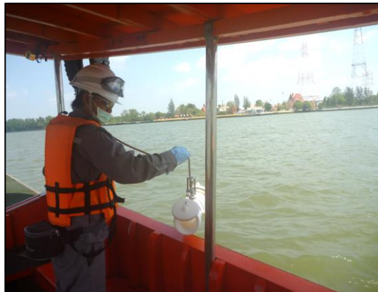
รูปที่ 3.9 การเก็บตัวอย่างคุณภาพน้ำในแม่น้ำเจ้าพระยา บริเวณ 100 เมตร เหนือจุดระบายน้ำทิ้งจากโครงการ (Upstream)
