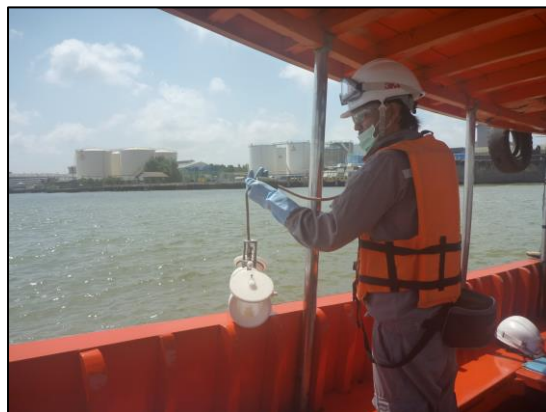
รูปที่ 3.10 การเก็บตัวอย่างคุณภาพน้ำในแม่น้ำเจ้าพระยา บริเวณ 100 เมตร ท้ายจุดระบายน้ำทิ้งจากโครงการ (Downstream)
