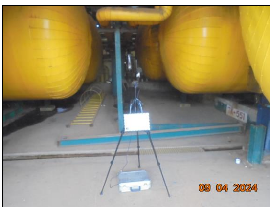
รูปที่ 3.25 การตรวจวัดระดับเสียงในพื้นที่ทำงาน บริเวณ หน่วยผลิตคลอรีนเหลว
