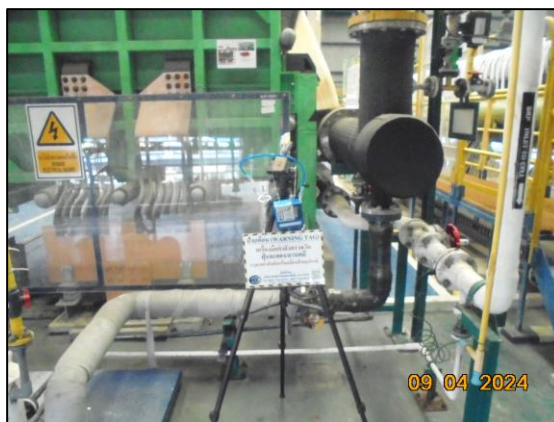
รูปที่ 3.21 การตรวจวัดคุณภาพอากาศในพื้นที่ทำงาน บริเวณ ห้อง Cell room MTA 7- 8
