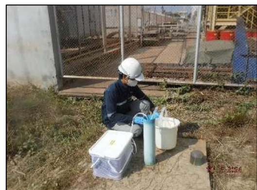
บริเวณบ่อสังเกตการณ์บริเวณทิศทางเหนือน้ำของ การไหลของน้ำใต้ดิน ระดับความลึก 18 เมตร (GW 1-2)
