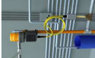
รูปที่ 7-5 Strobe light/Alarm Horn พร้อมสัญญาณโดย Flow Switch ซึ่งติดตั้งที่ห้องน้ำเข้าที่ล้างตัวและล้างตา
