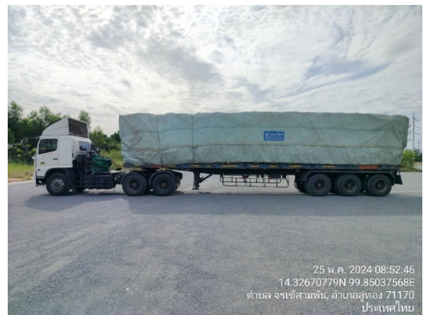
รูปที่ 2-34 การปิดคลุมรถบรรทุก ด้วยผ้าใบชนิดโพลีเอสเตอร์
