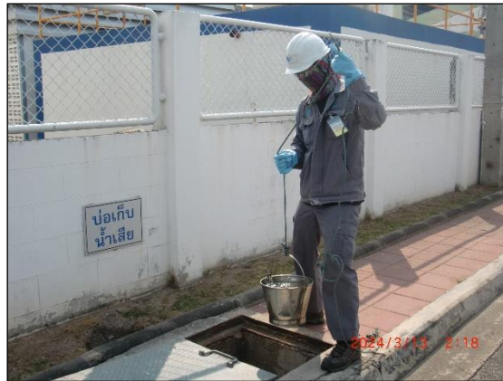
รูปที่ 3.1 การเก็บตัวอย่างน้ำ บริเวณจุดปล่อยน้ำทิ้งจุดที่ 1 จากโครงการเข้าสู่ระบบรวบรวมน้ำเสียของสวนอุตสาหกรรมเครือสหพัฒน์-ศรีราชา
