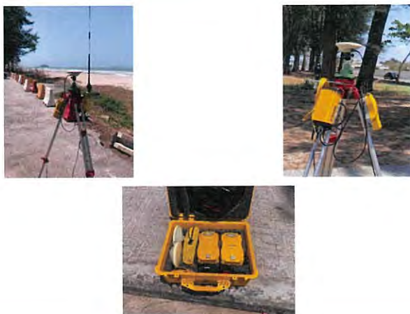
ภาพที่ 12 การติดตั้ง GPS.BASE STATION
