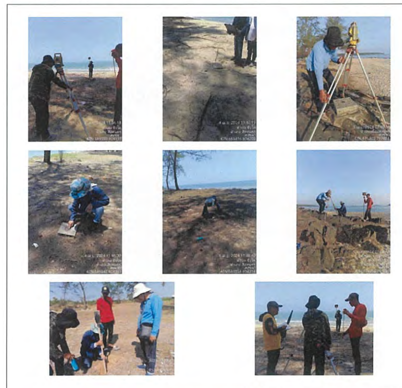
ภาพที่ 1 งานตรวจสอบหมุดหลักฐาน และหมุดอ้างอิงแนวชายฝั่ง
