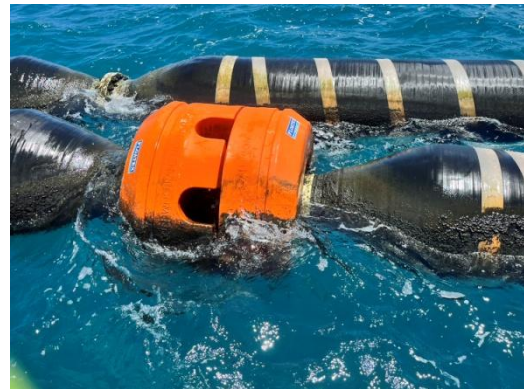
รูปที่ 3-34 อุปกรณ์ตัดแยกน้ำมันลูกเงิน (Break Away Coupling)
