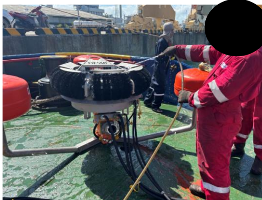
รูปที่ 3-40 อุปกรณ์รับมือน้ำมันหกรั่วไหลในเรือลากจูง
