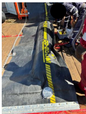
รูปที่ 3-40 อุปกรณ์รับมือน้ำมันหกรั่วไหลในเรือลากจูง
