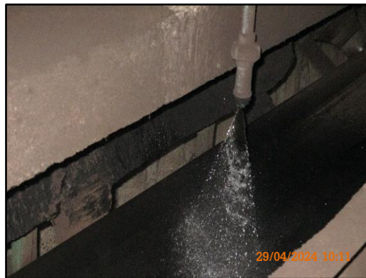
ภาพที่ 2.48 การฉีดพรมน้ำหรือสเปรย์น้ำบริเวณสายลำเลียงและกองเก็บถ่านหิน
