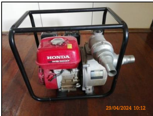
ภาพที่ 2.51 เครื่องปั๊มน้ำพร้อมสายยางสำหรับดูดน้ำและสายยางสำหรับฉีดน้ำดับเพลิงภายในเรือลำเลียงสินค้า
