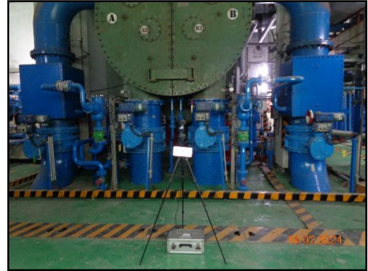
ภาพที่ 3.46 การตรวจวัดระดับเสียงของ เครื่องจักรบริเวณท่อส่งไอน้ำ
