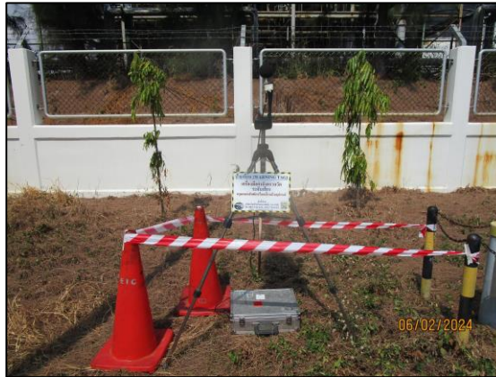
รูปที่ 4.13 การตรวจวัดระดับเสียงโดยทั่วไป บริเวณริมรั้วโรงงานด้านทิศเหนือ
