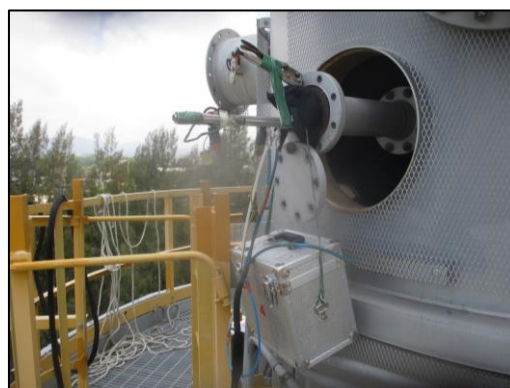
รูปที่ 4.2 การเก็บตัวอย่างคุณภาพอากาศในปล่องระบาย บริเวณปล่องของระบบ Thermal Oxidizer (TO)
