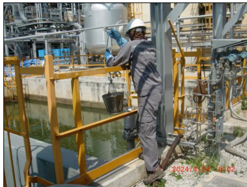
รูปที่ 4.6 การเก็บตัวอย่างคุณภาพน้ำทิ้ง บริเวณ Cooling Water Blowdown Hold Sump
