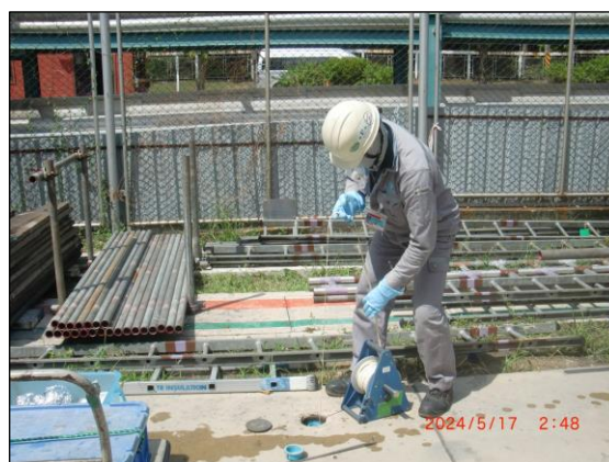
รูปที่ 4.9 การเก็บตัวอย่างคุณภาพน้ำใต้ดิน บริเวณทิศใต้ของพื้นที่โครงการ
