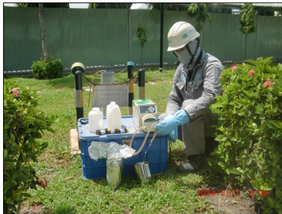
รูปที่ 4.8 การเก็บตัวอย่างคุณภาพน้ำใต้ดิน บริเวณทิศตะวันออกของพื้นที่โครงการ
