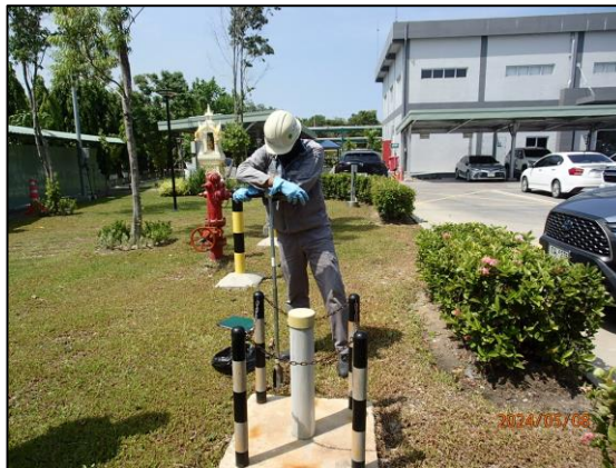
รูปที่ 4.11 การเก็บตัวอย่างคุณภาพดิน บริเวณทิศตะวันออกของพื้นที่โครงการ
