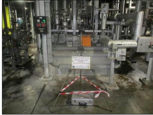
รูปที่ 4.17 การตรวจวัดระดับเสียงในพื้นที่ทำงาน บริเวณ พื้นที่กระบวนการผลิต บริเวณที่ 2
