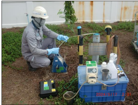
รูปที่ 4.7 การเก็บตัวอย่างคุณภาพน้ำใต้ดิน บริเวณทิศเหนือของพื้นที่โครงการ
