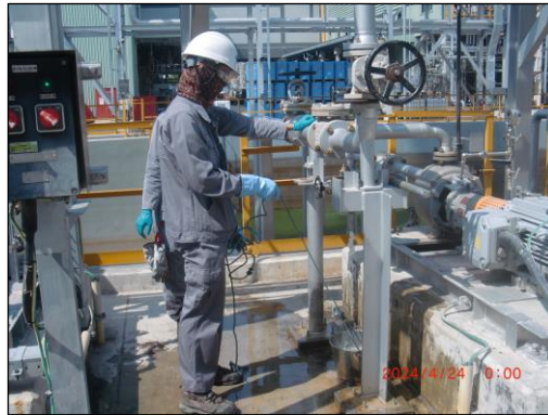
รูปที่ 4.5 การเก็บตัวอย่างคุณภาพน้ำทิ้ง บริเวณ Final Check Basin
