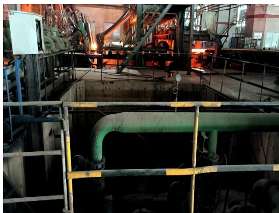
ภาพถ่ายที่ 2.2-12 บ่อรับน้ำที่ผ่านการหล่อเย็นบริเวณใต้เครื่องหล่อเหล็ก
