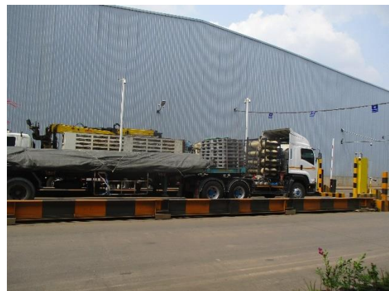
ภาพถ่ายที่ 2.2-3 อุปกรณ์ตรวจวัดกัมมันตรังสีแบบถาวร
