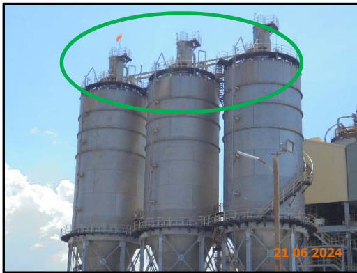
ภาพที่ 5 อุปกรณ์ดักฝุ่นแบบถุงกรองเพื่อดักฝุ่นจาก PTA Silo
