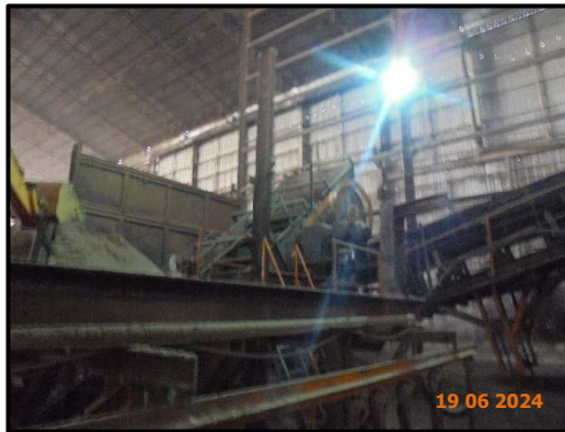
รูปที่ 7 ระบบสายพานลำเลียงแบบปิด
