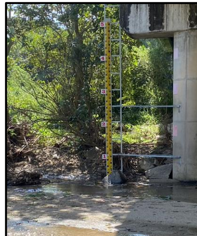
รูปที่ 5.2.1-3 การตั้งเลขบอกระดับหัวแผ่นวัดระดับน้ำ (Staff Guage)
