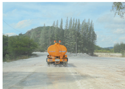
รูปที่ 2-11: การฉีดพรมน้ำบนเส้นทางขนส่งแร่
