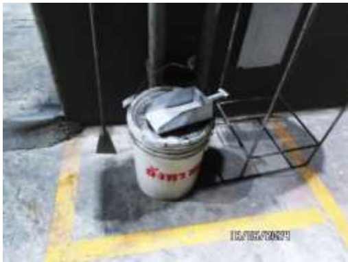
รูปที่ 32 อุปกรณ์ตอบสนองกรณีสารเคมีหกั่วไหล
