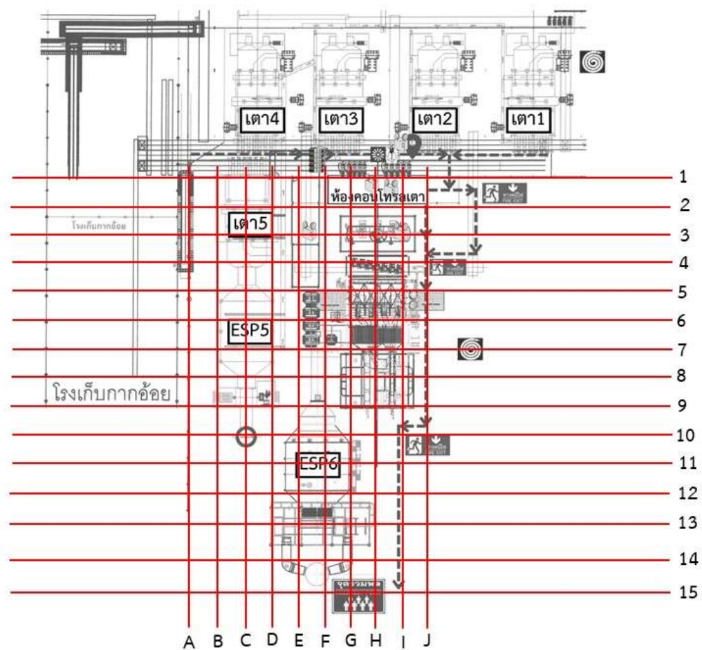
รูปที่ 3.4-20 ตำแหน่งตรวจวัดระดับเสียงเพื่อจัดทำแผนผังแสดงระดับเสียง (Noise Contour) บริเวณแผนกหม้อไอน้ำ (เตา 5 และ 6)
