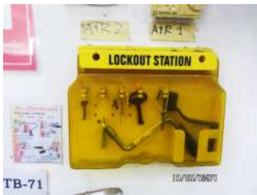
รูปที่ 35 อุปกรณ์ระบบ Log out-Tag out
