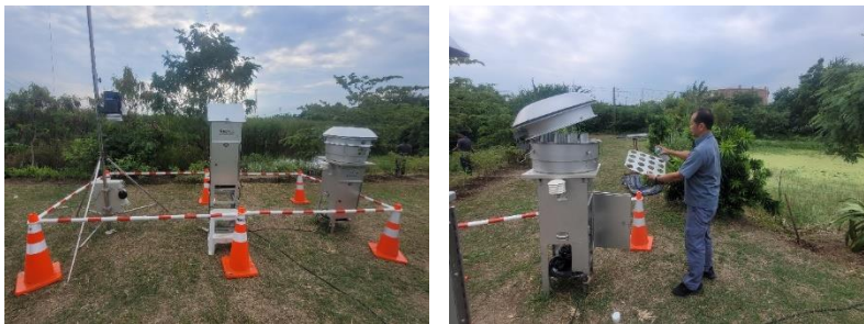
รูปที่ ค-92 การตรวจวัดคุณภาพอากาศในบรรยากาศโดยทั่วไป บริเวณกลุ่มบ้านพักอาศัยใกล้พื้นที่ก่อสร้างสถานี MR ระหว่างวันที่ 20-24 ตุลาคม 2565
