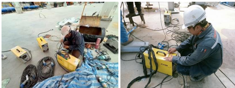
รูปที่ ค-73 ตรวจสอบสภาพเครื่องเชื่อมท่อก๊าซให้อยู่ในสภาพพร้อมใช้งาน
