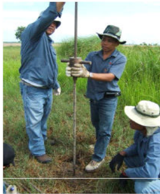
รูปที่ 1.13 ตัวอย่างวิธีการเจาะสำรวจดินด้วยวิธี Kunzel Stab & Hand Auger
