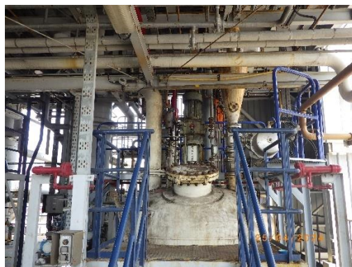
รูปที่ 2-79 ถังเกิดปฏิกิริยา (PLY-101/PLY-101Zs) ออกแบบตามมาตรฐาน ASTM SECT VIII DIV 1
