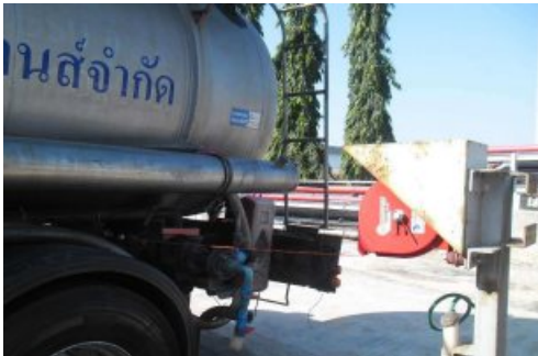
รูปที่ 32 ภาพการต่อสายกราวด์ เพื่อป้องกันไฟฟ้าสถิตย์
