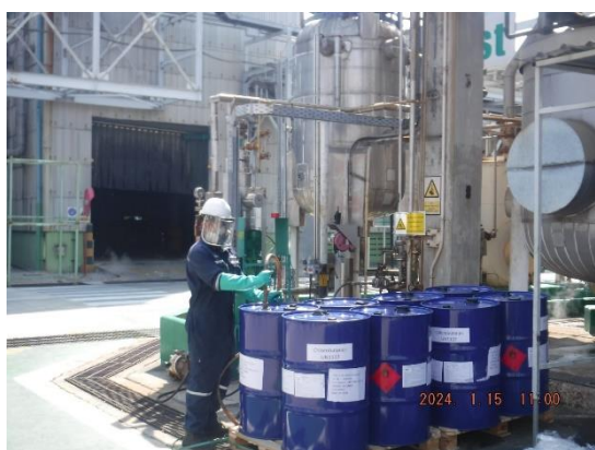
รูปที่ 2-94 จุดโหลดสารเทอร์เทียรีบิวทิลคลอไรด์ ขณะทำการขนถ่าย
