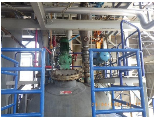
รูปที่ 2-79 ถังเกิดปฏิกิริยา (PLY-101/PLY-101Zs) ออกแบบตามมาตรฐาน ASTM SECT VIII DIV 1
