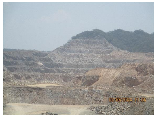
รูปที่ 2-25 ลักษณะการทำเหมืองแบบขั้นบันได
