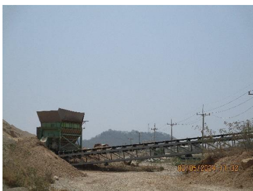
รูปที่ 2-9 โรงย่อยหินแบบ Semi Mobile Crusher
