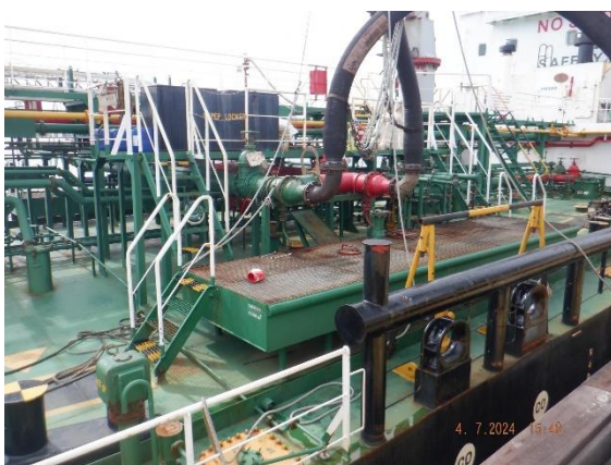
รูปที่ 2-19 ถาดรองรับน้ำมันที่อาจรั่วจากการต่อเชื่อมท่อสุบถ่าย
