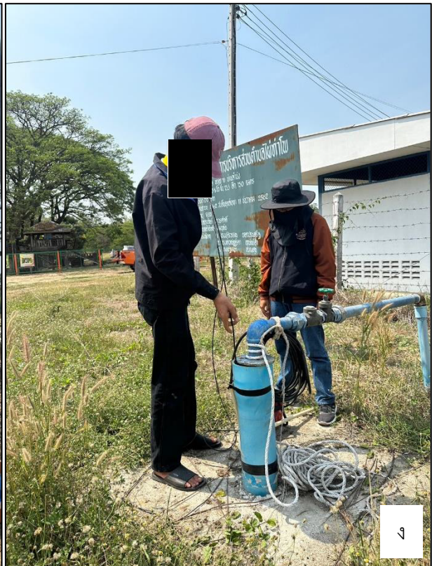
ภาพที่ 5.2.3-5 การวัดระดับน้ำใต้ดินจากบ่อบาดาลในพื้นที่โครงการประจวบฯ น้ำโพธิ์ประทับช้าง
