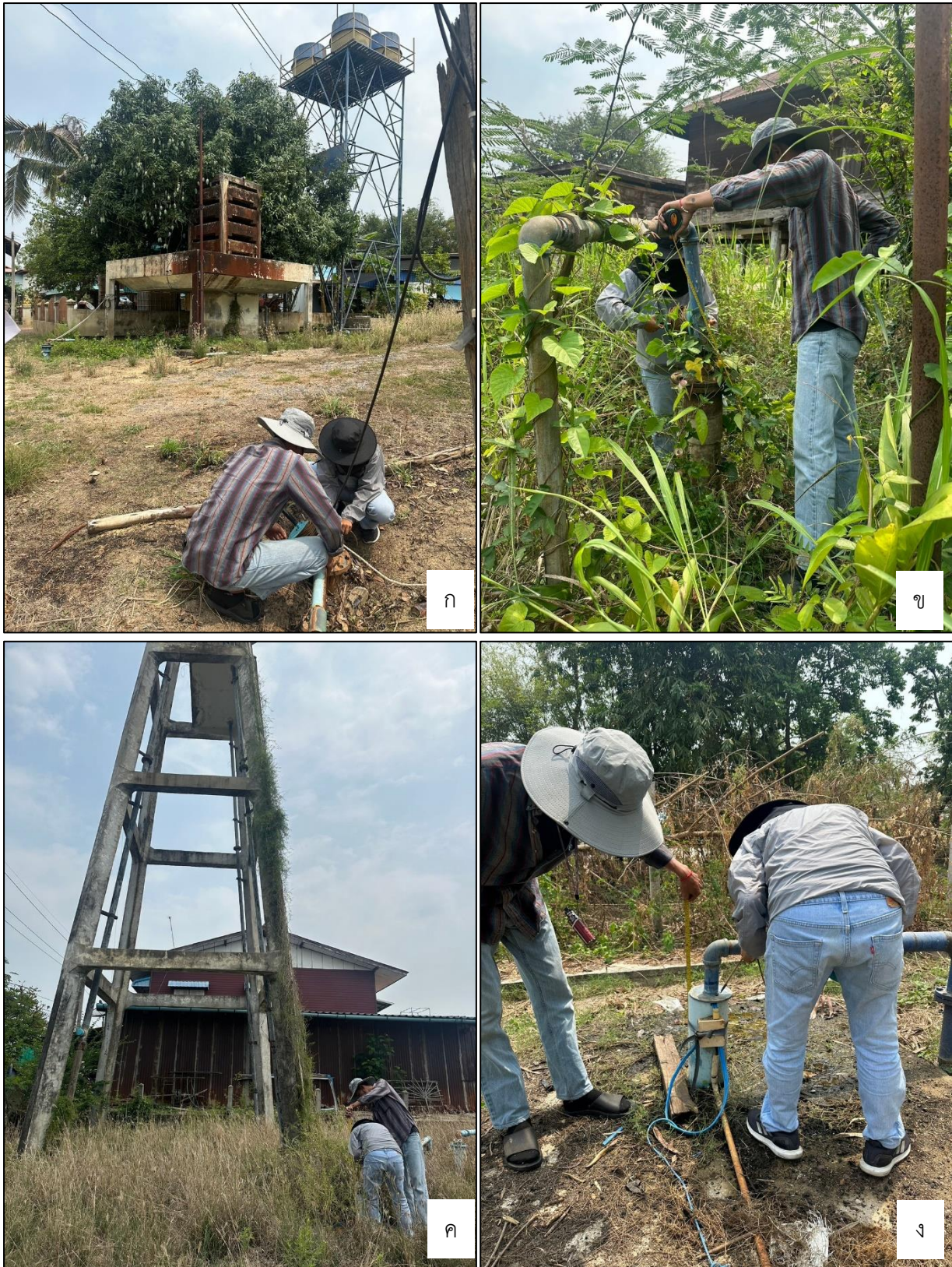
ภาพที่ 5.2.3-4 การวัดระดับน้ำใต้ดินจากบ่อบาดาลในพื้นที่โครงการประจวบฯ น้ำโพธิ์ประทับช้าง (ก) TC02 ประปาหมู่บ้าน ช่างบ้านหลังสี่ฟ้า (ข) TC04 บ้านเก่า (ค) TC05 ประปา อบต. บางลาย (ง) TC06 ประปาหมู่บ้านช่างโรงเรียน (คอกหมู)
