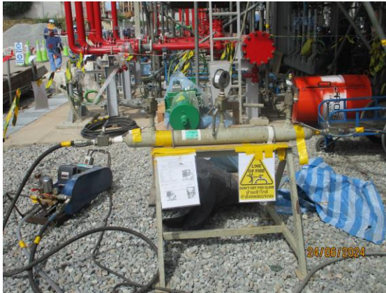
รูปที่ 2-13 เครื่องทดสอบแรงดันของท่อ (Hydrostatic Test)
