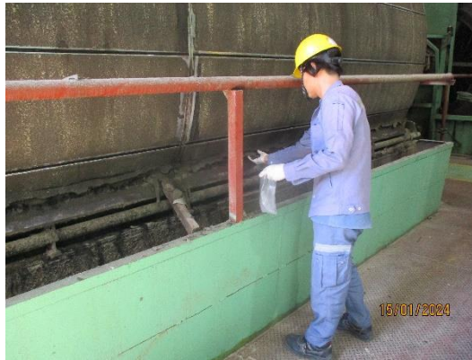
รูปที่ 3.4-11 การเก็บตัวอย่างกากตะกอนหม้อกรองของโครงการ
