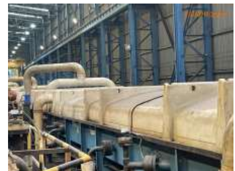
ภาพที่ 2-5 ระบบรางที่มีฝาปิดและมีเครื่องดูด รวบรวมไอรกใน Pickling Oil Plant
