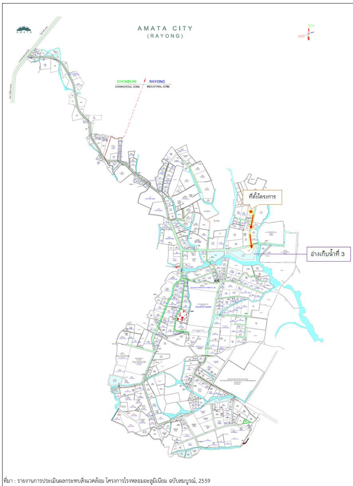
รูปที่ 1.6-3 ทิศทางการไหลของน้ำฝนไปยังบ่อหน่วงน้ำของนิคมอุตสาหกรรมอมตะซิตี้ ระยอง
