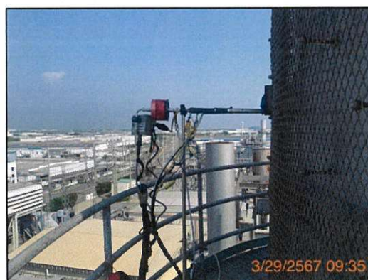
ภาพถ่ายที่ 3.5.1.1-1 ขณะดำเนินการตรวจวัดคุณภาพอากาศจากปล่อง HRSG#1 (CTG#1)
