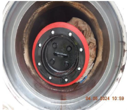
รูปที่ 2-2 การทำความสะอาดท่อน้ำมันด้วย Cleaning Pig
