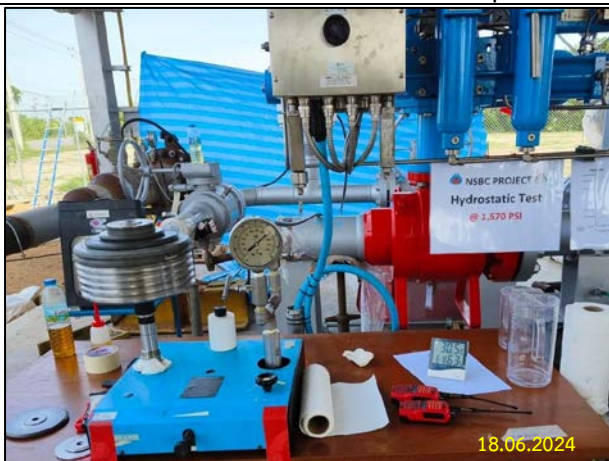
ง) การทดสอบท่อด้วยวิธีทางชลสถิต (Hydrostatic Test)
