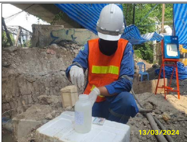
การเก็บตัวอย่างน้ำทิ้งจากการทดสอบท่อฯ ด้วยวิธีทางชลสถิต (Hydrostatic Test) ครั้งที่ 2 เมื่อวันที่ 13 มีนาคม พ.ศ. 2567
