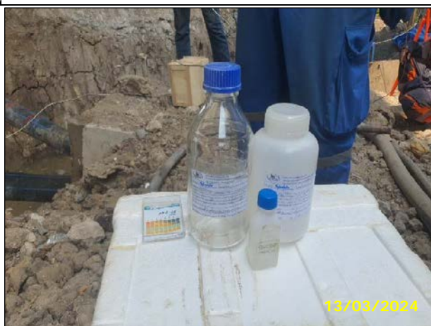
การเก็บตัวอย่างน้ำทิ้งจากการทดสอบท่อฯ ด้วยวิธีทางชลสถิต (Hydrostatic Test) ครั้งที่ 2 เมื่อวันที่ 13 มีนาคม พ.ศ. 2567
