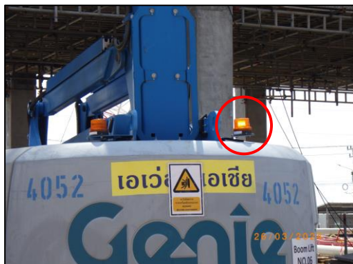
รูปที่ 2-72 ไฟสัญญาณที่ท้ายเครื่องจักร
