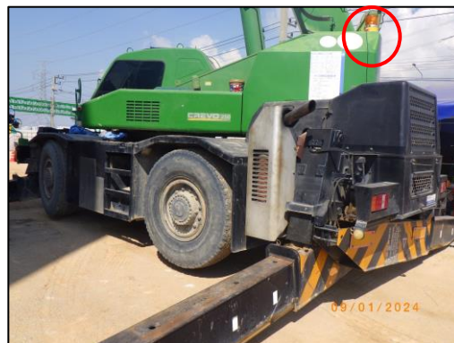
รูปที่ 2-72 ไฟสัญญาณที่ท้ายเครื่องจักร
