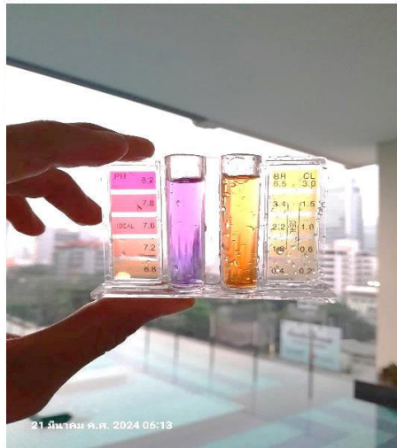
รูปภาพที่ 21 ภาพการวัดค่ากรด-ด่างสระ ว่ายน้ำ
