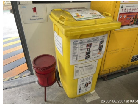
ภาพที่ 2-30 อุปกรณ์ตอบสนองกรณีสารเคมีหกั่วไหล
