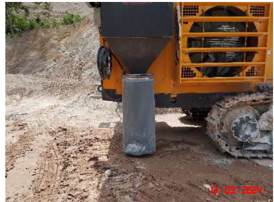
รูปที่ 13 เครื่องเจาะระเบิดที่มีอุปกรณ์ดูดฝุ่นติดไว้บริเวณหัวเจาะ
