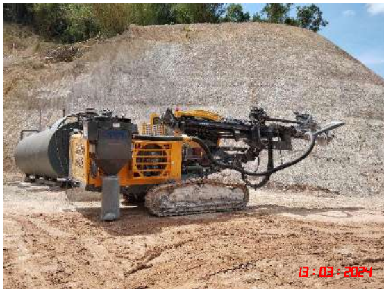
รูปที่ 13 เครื่องเจาะระเบิดที่มีอุปกรณ์ดูดฝุ่นติดไว้บริเวณหัวเจาะ
