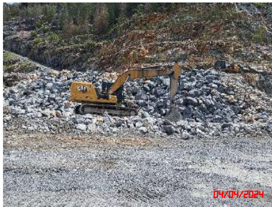
รูปที่ 8 การตักขนก้อนแร่และเศษหินบริเวณด้านบนของหน้าระเบิด
