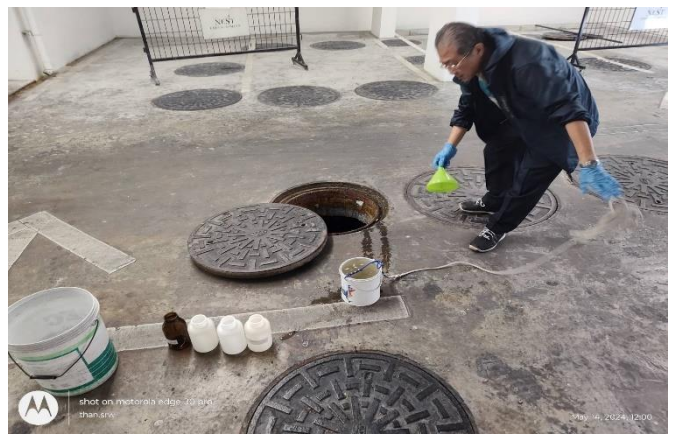
รูปที่ 1.6-2 เก็บตัวอย่างน้ำเสียเพื่อตรวจสอบ
