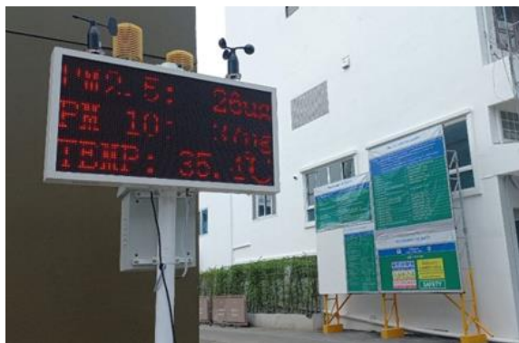
รูปที่ ก-9 การติดตั้งระบบติดตามตรวจสอบ คุณภาพสิ่งแวดล้อมแบบเรียลไทม์ผ่านหน้าจอแสดงผล
