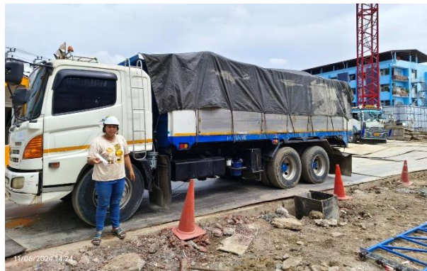
รูปที่ ก-16 รถบรรทุกที่ใช้ขนส่งวัสดุก่อสร้างมีผ้าใบคลุมอย่างมิดชิดหรือมีผนังกันส่วบรรทุกโดยรอบ
