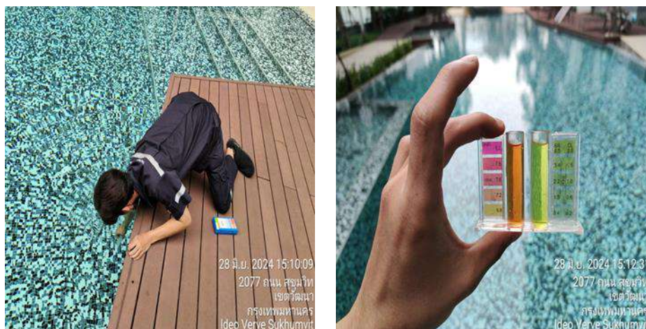
ภาพที่ 4.6.2 การตรวจวัด pH และ Free Chlorine สระว่ายน้ำ
