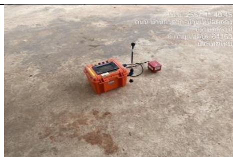
รูป AE ตรวจวัดแรงสั่นสะเทือน และแรงอัด อากาศจากการใช้วัตถุระเบิดของโครงการจำนวน 2 สถานี
