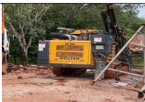
รูป V : มีการใช้เครื่องเจาะรูระเบิดแบบ Hydraulic Crawler Drill
