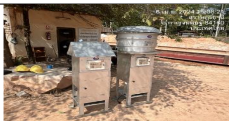
รูป AB ตรวจวัดปริมาณฝุ่นละอองแขวนลอยในบรรยากาศ TSP และ PM10 เฉลี่ยในรอบ 24 ชั่วโมงเป็นเวลา 3 วัน ต่อเนื่อง โดยใช้เครื่อง High Volume Air Sampler จำนวน 4 สถานี
