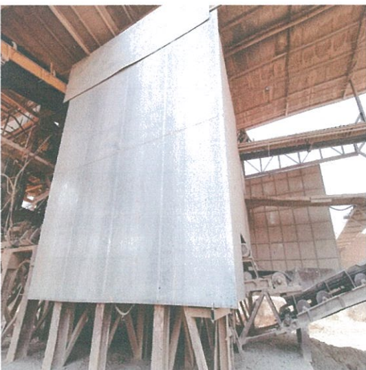
รูปที่ 11 การปิดคลุมอาคารโรงโม่หินชุด Hopper และ Primary Crusher
