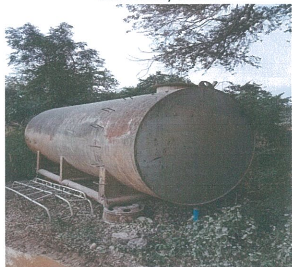
รูปที่ 12 ถังเก็บน้ำสำหรับประพรมในโรงโม่หิน
