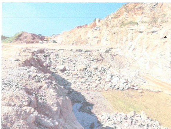
รูปที่ 2 การเปิดหน้าเหมืองเป็นชั้นบันได บริเวณตอนกลางของประทานบัตร
