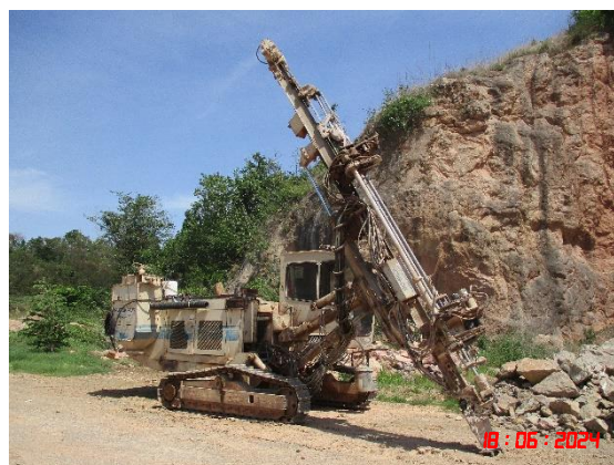
รูปที่ 11 เครื่องเจาะระเบิดที่มีอุปกรณ์เก็บฝุ่นติดไว้กับหัวเจาะ
