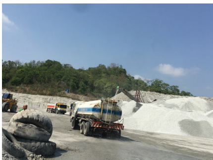
รูปที่ 2-7: การฉีดพรมน้ำบริเวณลานกองแร่
