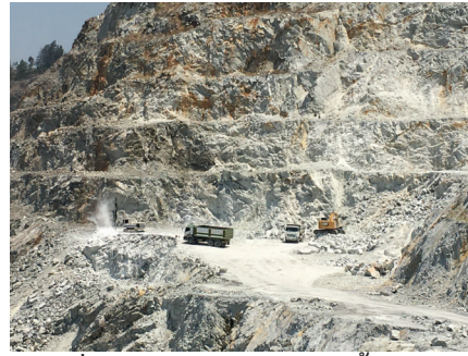
รูปที่ 2-2: การทำเหมืองแบบขั้นบันได
