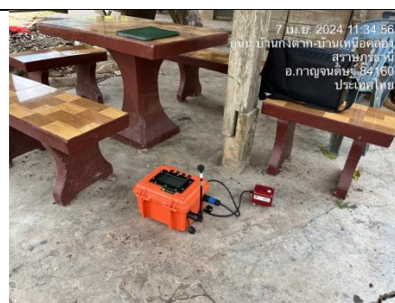
รูป AG ตรวจวัดแรงสั่นสะเทือน และแรงอัดอากาศจากการทำเหมือง จำนวน 2 สถานี
