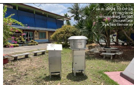
รูป AE ตรวจวัดปริมาณฝุ่นละอองรวม (TSP) และปริมาณฝุ่นละอองขนาดเล็กไม่เกิน 10 ไมครอน (PM10) จำนวน 3 สถานี
