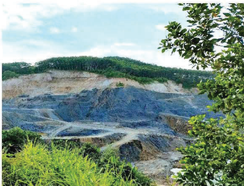
บริเวณหน้าเหมืองมีการปรับเป็นขั้นบันไดและลดความลาดชัน
