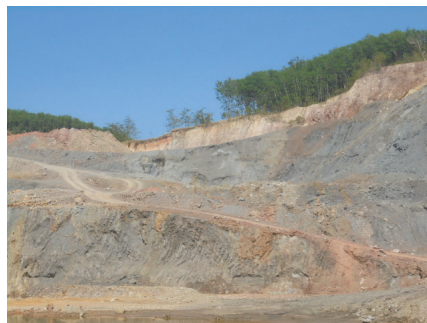
รูปที่ 2-17: การทำเหมืองแบบขั้นบันได
