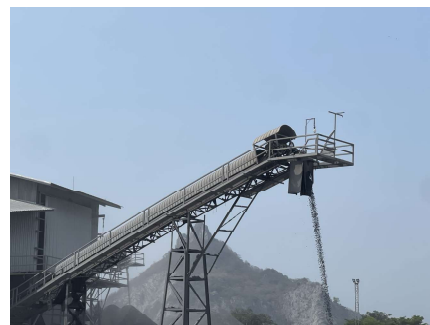
รูปที่ 2-30: การปิดคลุมสายพานลำเลียงแร่
