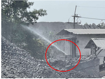
รูปที่ 2-33: ระบบสเปรย์น้ำของโรงโม่หิน
