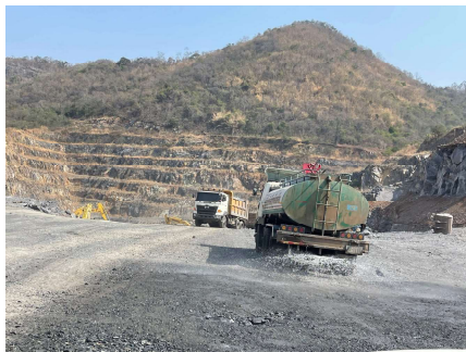
รูปที่ 2-27: การฉีดพรมน้ำบริเวณหน้าเหมือง
