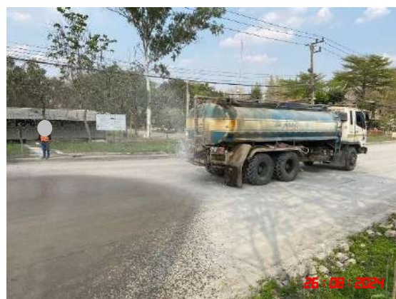
รูปที่ 7 การฉีดพรมน้ำบนเส้นทางขนส่งแร่
