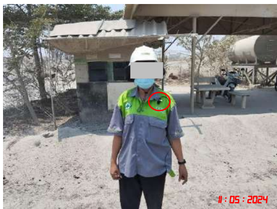
รูปที่ 27 การตรวจวัดระดับความดังเสียง (Noise Dose) เมื่อวันที่ 11 พฤษภาคม 2567
