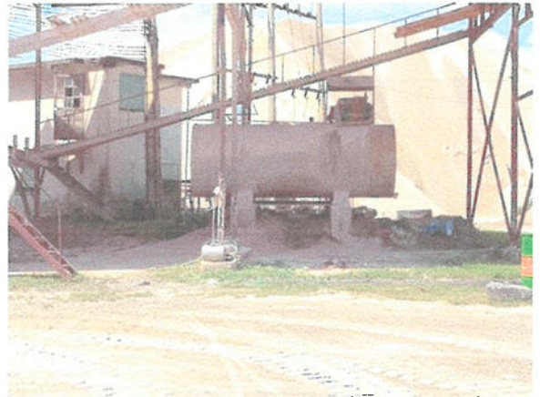
รูปที่ 22 ถังเก็บน้ำสำหรับสเปรย์น้ำในโรงโม่หิน
