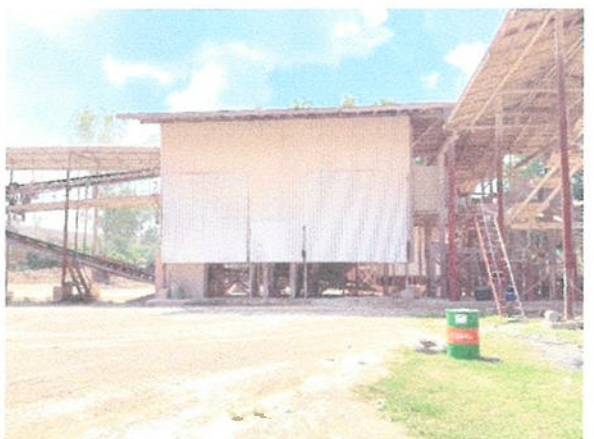
รูปที่ 18 การปิดคลุมอาคารโรงโม่หิน ชุด Secondary และ Tertiary Crusher
