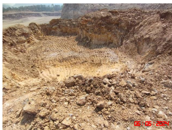
รูปที่ 15 บ่อรับน้ำ (Sump) ขุมเหมือง
