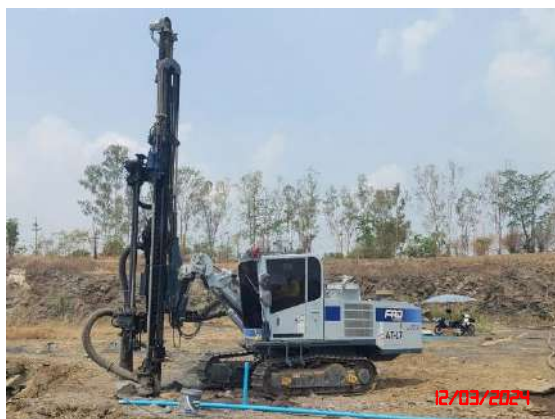
รูปที่ 7 เครื่องเจาะรูระเบิดที่มีอุปกรณ์เก็บฝุ่นติดไว้ที่หัวเจาะ
