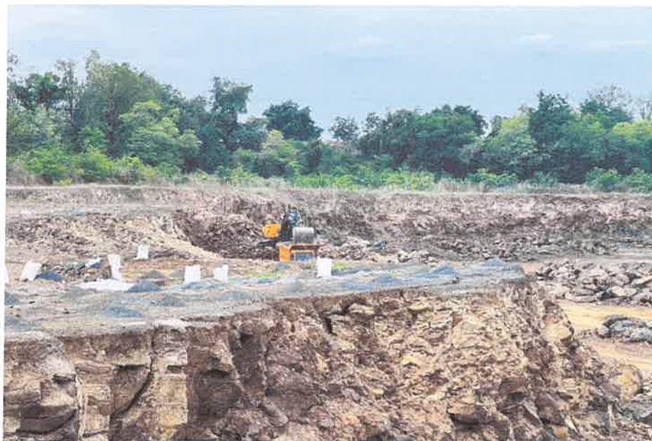
รูปที่ ๒ เปิดหน้าเหมืองเป็นชั้นบันได (Bench) และปรับความลาดชันให้หน้าเหมืองมีความมั่นคง แข็งแรง และปลอดภัย
